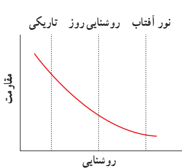
شکل ۲-۲۰ مقاومت بر حسب روشنایی برای یک LDR نوعی
